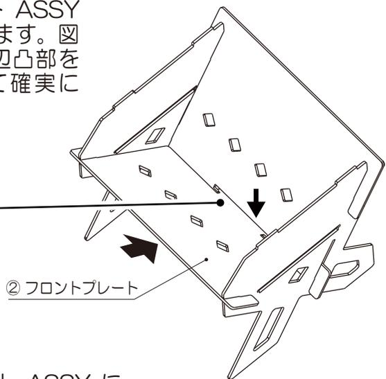
3. 手順 2 で組み付けた①②③プレート ASSY に④ロストルを差し込み、図を参考に④ロストルの両端凸部を③サイドプレートの溝に落として確実にロックしてください。
