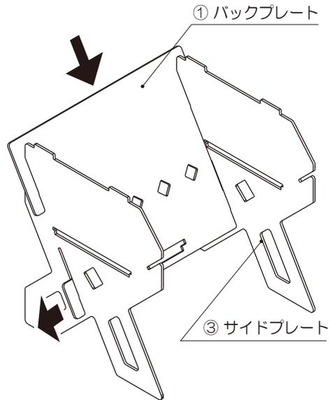
2. 手順 1 で組み付けた①②プレート ASSY に②フロントプレートを組み付けます。図を参考に②フロントプレートの底辺凸部を①バックプレートの溝に落として確実にロックしてください。
